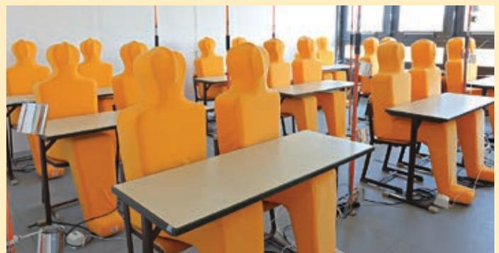
**Abb. 9** Fassadengestaltung in Klassenräumen: eine getrennte Zu- und Abluftführung in der Fassade ist günstiger (rechts im Bild) als eine einzige Öffnung für Zu- und Abluft, wie z. B. bei nur einer Reihe gekippter Fenster (links)
