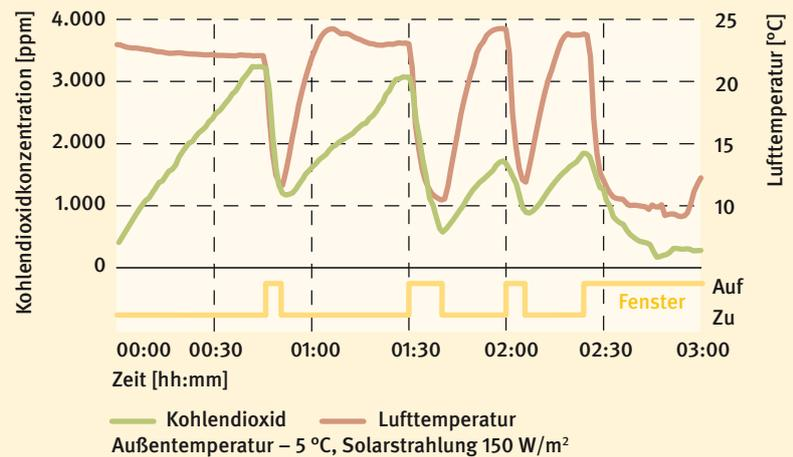
Abb. 3 Kohlendioxidverlauf bei Stoßlüftung in einem Testklassenraum mit Belegung durch 24 CO<sub>2</sub>-abgebende Dummies
